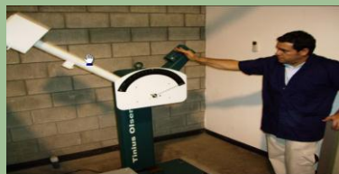
Máquina de Impacto: Por el método de Charpa, para medir la tenacidad de materiales metálicos.
