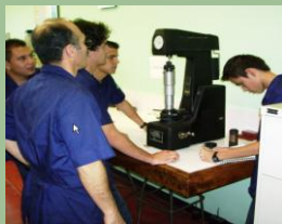
Durómetro Mecánico: Para medición de dureza de metales.
