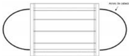
Figura 1 – Ejemplo de mascarilla higiénica formada con áreas de material elástico con sujeción en los arcos
