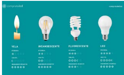
Imagen 2: Comparativa de eficiencia, vida útil y rendimiento cromático para el bombillo incandescente, fluorescente compacto y bombillo LED.
