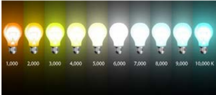
Imagen 3: temperatura del color y tono del bombillo para un valor específico.
